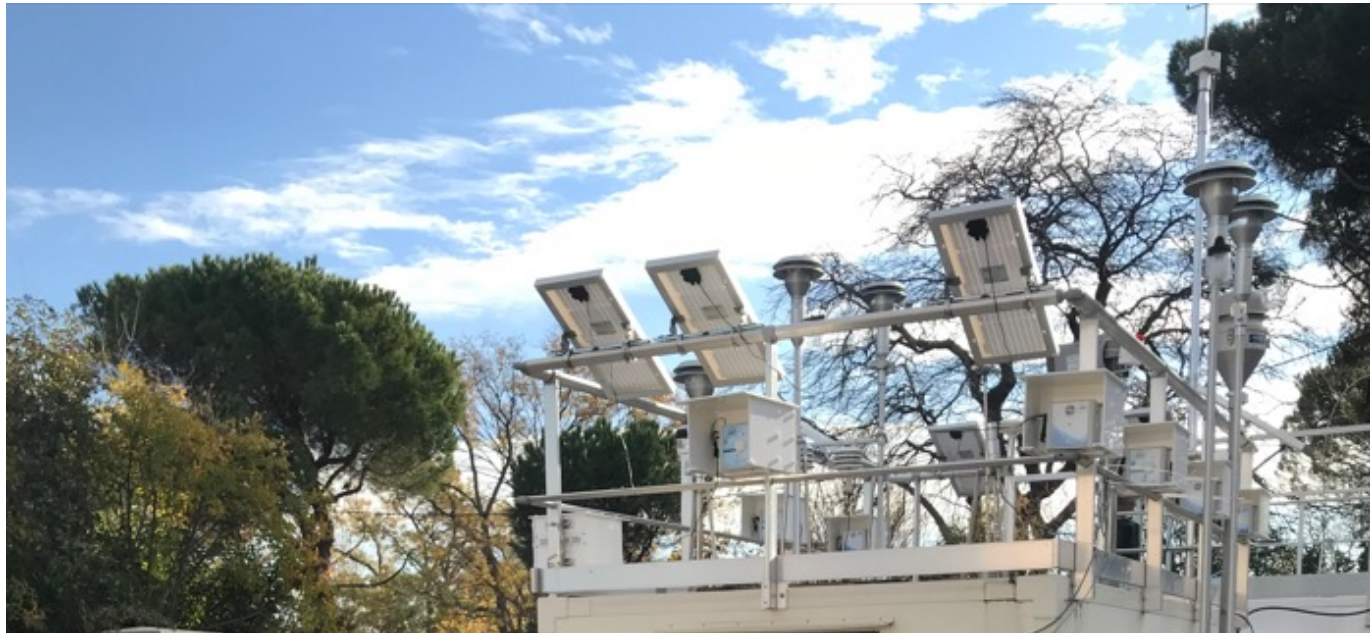
Microcapteurs sur le toit d'une station de référence – Marseille Longchamp
